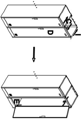
Presione hacia arriba el estante de techo F, fijar la parte trasera de F mediante los tornillos y fijar la parte delantera de F con el marco de la puerta, doblando las pestañas hasta la posición vertical.
