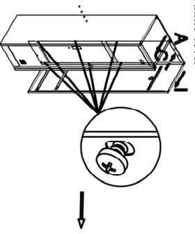
Ensamble la puerta con marco D, con el panel de unión C y con el panel derecho I.
