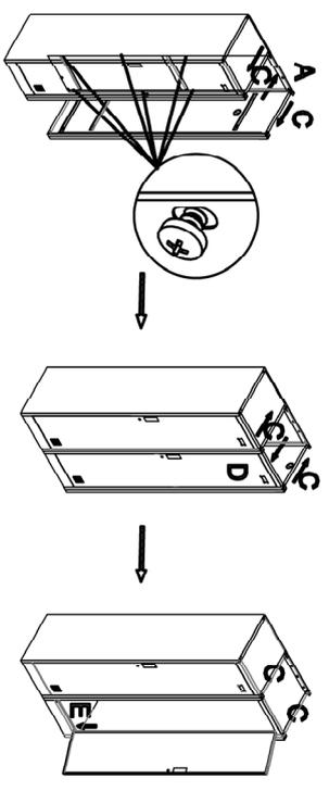
Presione hacia arriba el estante de techo F, fijar la parte trasera de F con el panel trasero A mediante los tornillos, fijar la parte frontal de F con el marco de la puerta doblando las pestañas hasta la posición vertical.
